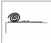
Fig. 7: Material de alfombras como absorbente de ruido.
