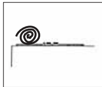
Abb. 7: Dickes Teppichmaterial als Schallabsorber
