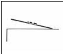
Fig. 6: Montaje del micrófono en una plancha de plexiglas.
