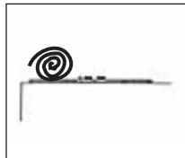
Fig. 7: material de tapete espesso para atenuar ruídos
